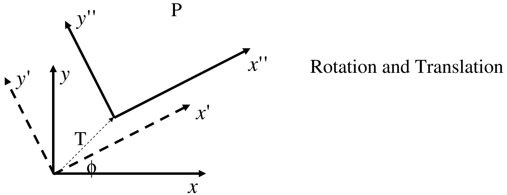
$$p' = \begin{bmatrix} p_x' \\ p_y' \end{bmatrix} = \begin{bmatrix} \cos\phi & \sin\phi \\ -\sin\phi & \cos\phi \end{bmatrix} \begin{bmatrix} p_x \\ p_y \end{bmatrix}$$
