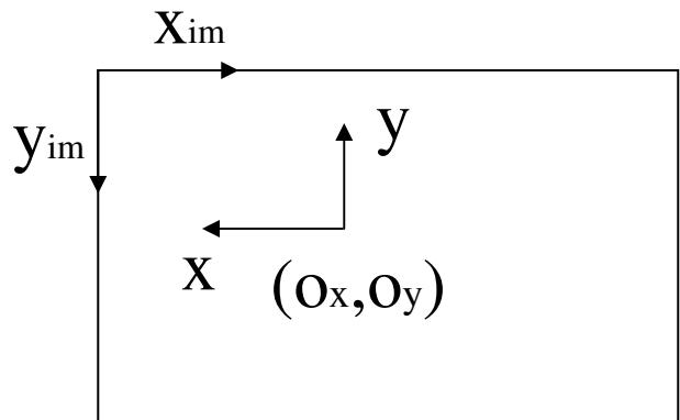
$$\begin{bmatrix} x_{im} \\ y_{im} \\ 1 \end{bmatrix} = \begin{bmatrix} -1/s_x & 0 & o_x \\ 0 & -1/s_y & o_y \\ 0 & 0 & 1 \end{bmatrix} \begin{bmatrix} x \\ y \\ 1 \end{bmatrix}$$
